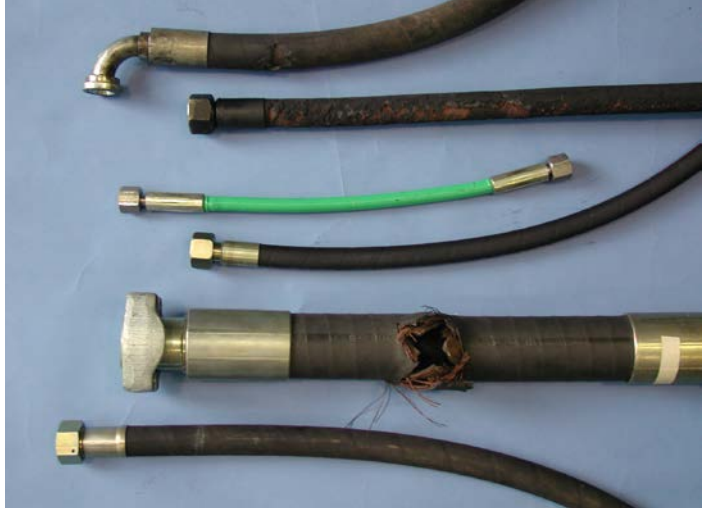
Abb. 16 Beispiele ausgefallener Hydraulik- Schlauchleitungen
