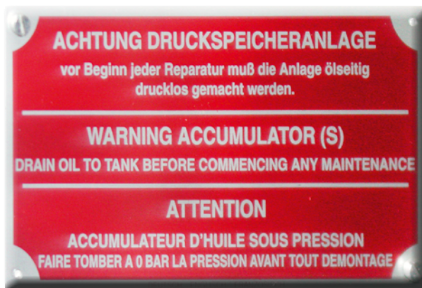
Abb. 21 Warnhinweis an Druckspeicheranlage
