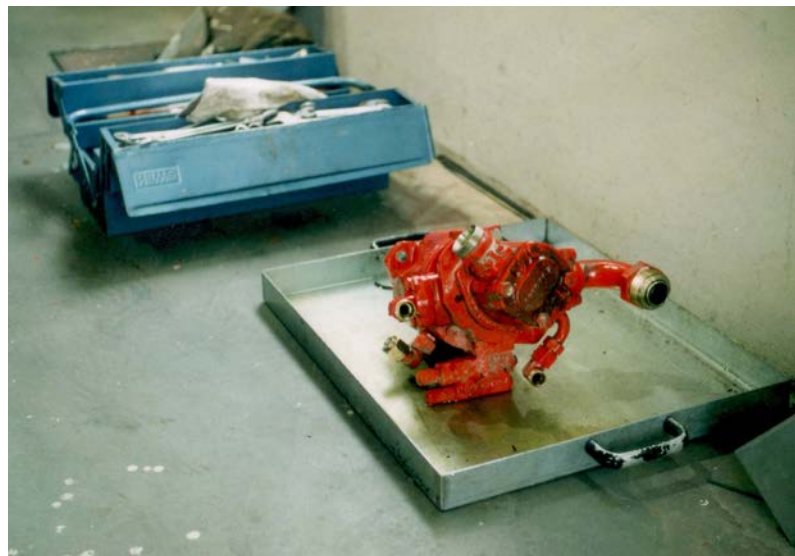
Abb. 19 Mobilhydraulik- pumpe in einer Ölauffangwanne
